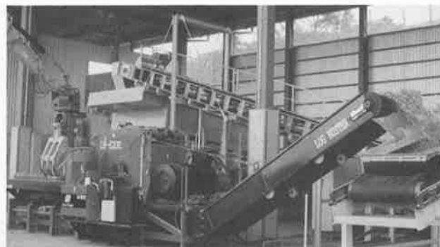
径60cmまでの丸太を高速でチップ化できるオランダ製のログバスター。
